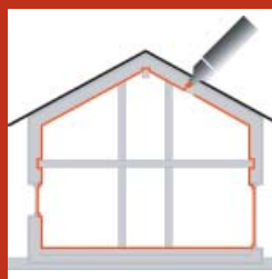
Obr. 5 Neprůvzdušnost zajišťuje spojitá vzduchotěsná vrstva, která musí být precizně vyhotovena. Kromě tepelných ztrát tato vrstva chrání konstrukce před vlhkostí, která se šíří přes netěsnosti.
