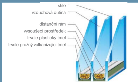
Obr. 7 Teplé rámečky by měly být u oken pro pasivní domy samozřejmostí. Na obrázku je řez izolačním zasklením s teplým distančním rámečkem.
