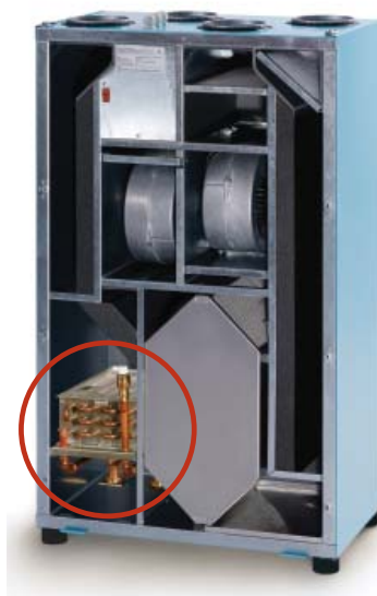
Obr. 6 Nízkoteplotní teplovodní nebo elektrický ohřivač přiváděného vzduchu umožňuje efektivní spojení větrání a teplovzdušného vytápění. Odpadá zde potřeba dalších rozvodů a klasického otopného systému při stejném komfortu.
