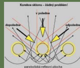
Obr. 4 Vakuové trubkové kolektory se vyznačují velkými výkony i při různém sklonu a natočení. Zejména v přechodném období zabezpečují oproti plochým kolektorům větší zisky.
