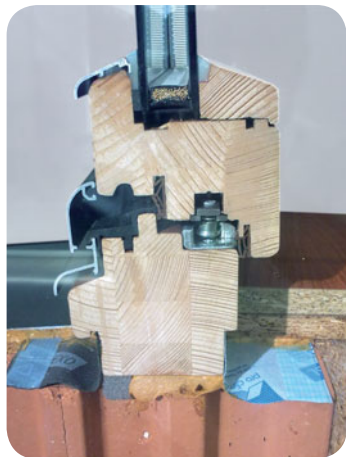
Detail řešení připojovací spáry (exponát součástí stálé expozice v Centru energetického poradenství PRE)
