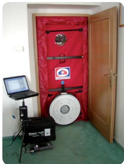
Blower Door test – interiér
