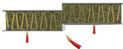
Tepelný most – uskočení
