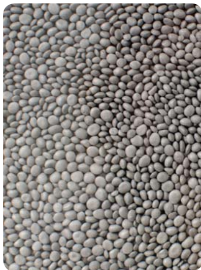
Easy-fill – polystyren s příměsí grafitu
