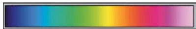
Termovizní škála: modrá část ukazuje místa s nejnižší teplotou (nízké ztráty), ve fialové a bílé části jsou teploty nejvyšší (vysoké ztráty)
