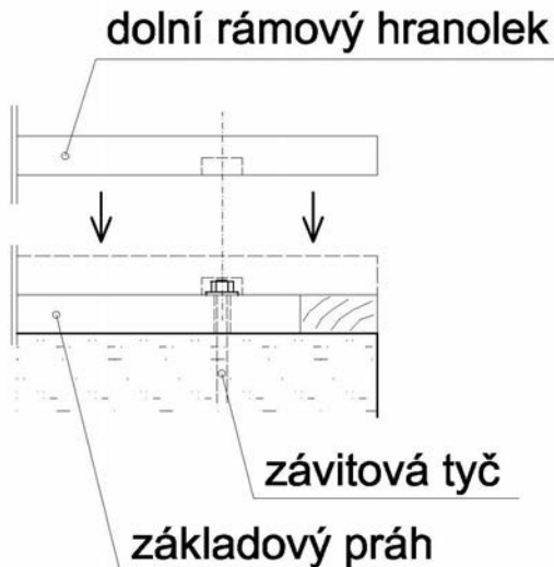
Obr. 31 - Otvory pro závitové tyče v dolním rámovém hranolku
