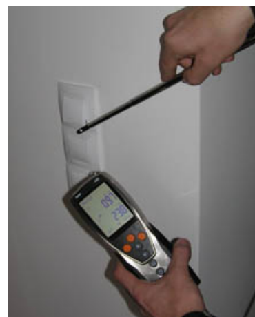
Obr. 116 - Anemometr pro měření rychlosti proudění vzduchu
