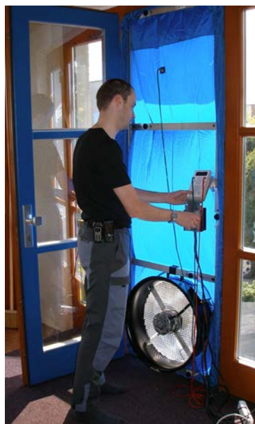
Obr. 112 - Ventilátor blower-door testu v průběhu měření
