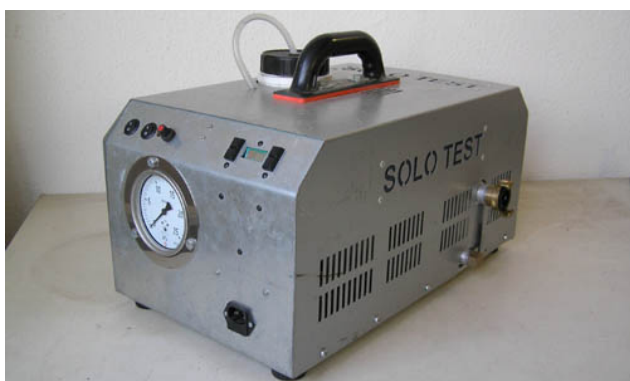
Obr. 115 - Zařízení Solotest pro tvorbu umělého kouře
