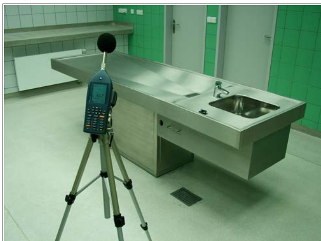
Obr. 43 - Měření hluku ve vnitřním chráněném prostoru stavby
