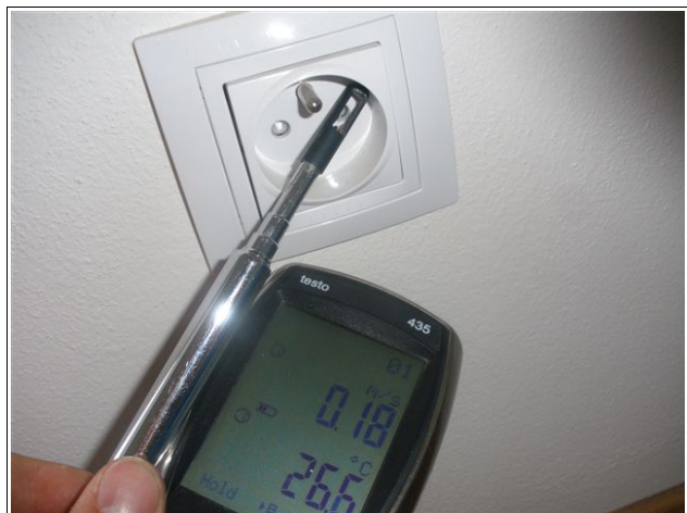
Obr. 42 - Použití anemometru při podtlaku – změřena rychlost proudění vzduchu do interiéru 0,18 m/s
