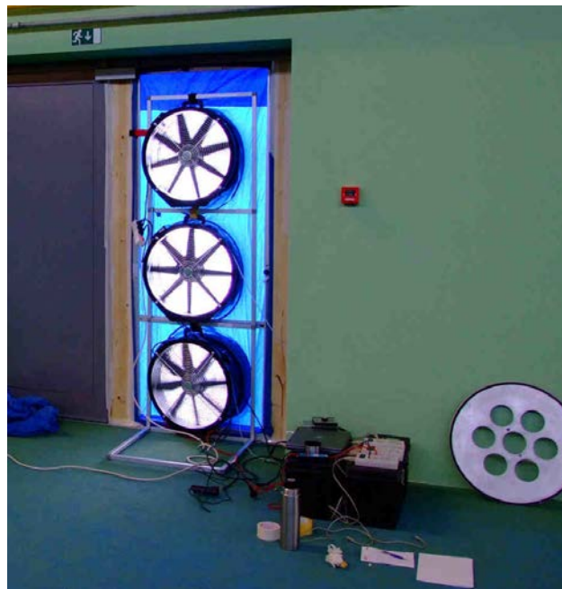
Obr. 40 - Zařízení blower door se sestavou tří ventilátorů určené pro měření větších objektů
