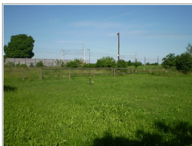
Obr. 46 - Mikrofon na stativu při měření hluku z železniční dopravy na pozemku, kde je plánována výstavba rodinného domu
