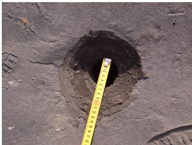
foto /35/ Vnitřní vtok se změřeným průměrem 60 mm
