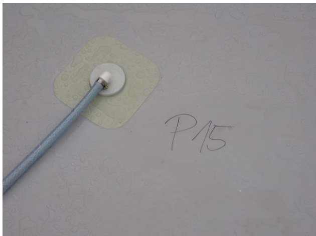
foto /68/ Osazená kontrolní trubice; označení sektoru
