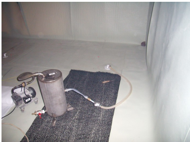
foto /20/ Podtlaková zkouška těsnosti jednoho z podlahových sektorů
