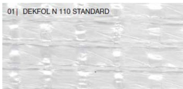
Obr. 66 - Příklad fólie lehkého typu DEKFOL
