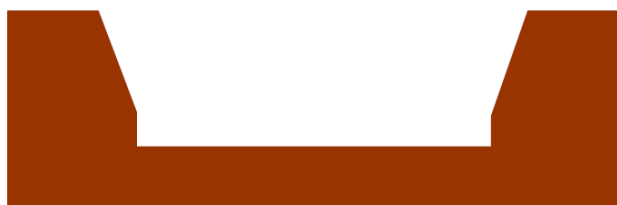
Obr. 54 – Stavební jáma (zajištění stěn svahováním)
