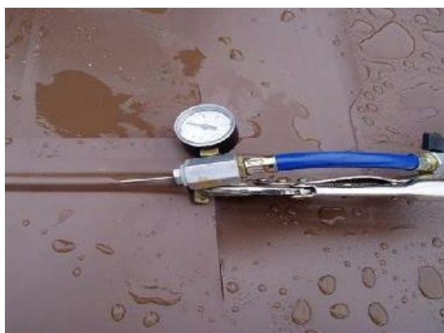
Obr. 36 – Tlaková zkouška těsnosti spojů
