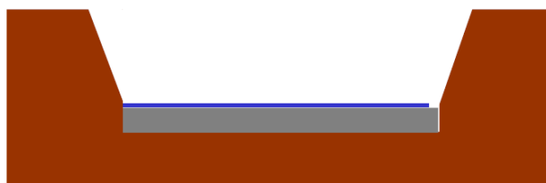
Obr. 55 – Provedení vodorovné hydroizolace na základovou konstrukci (základovou desku)
