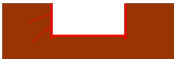
Obr. 51 – Zajištění stavební jámy (podkladní beton, pažení stěn)
