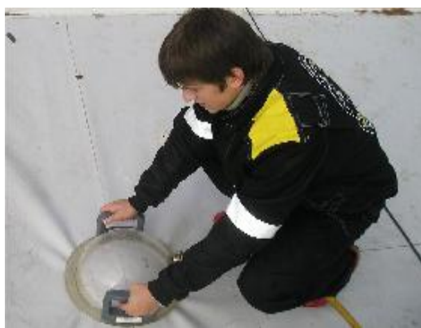
Obr. 37 – Podtlaková zkouška těsnosti spojů zvonem
