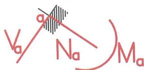
c) Pomocí silové podmínky rovnováhy do osy nosníku vypočítáme reakci  $N_a$ .
